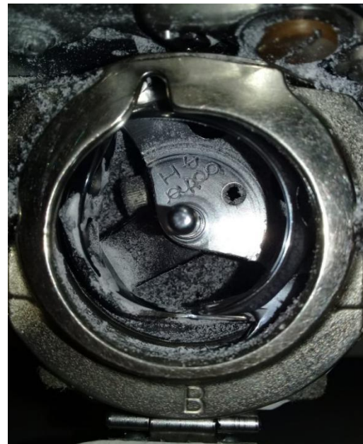
Gambar 11. Kondisi Rotari hook dalam keadaan kotor
