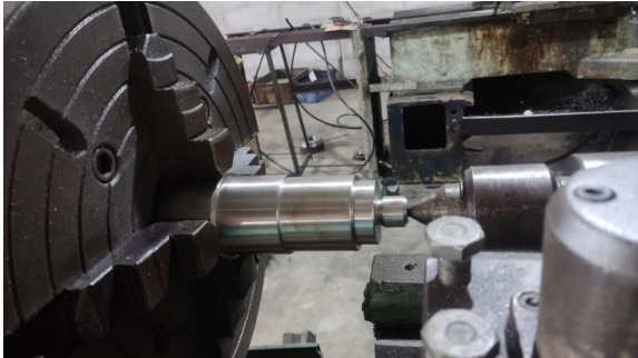
Gambar 6. Proses Bubut Rata untuk Bushing Bronze
