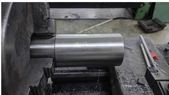
Gambar 5. Proses Bubut Rata Bertingkat untuk tempat pasak
